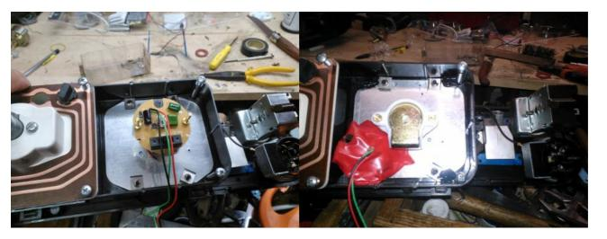
Etape 8 : détacher la partie électronique du nouveau compte tours, (sinon l'ensemble est trop haut pour le placer dans le tableau de bord), bien l'isoler avec du scotch.
