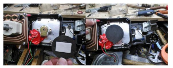
Etape 10 : Placer le fond du compte tour d'origine sur l'ensemble, le visseravec les vis d'origine. (L'ensemble tien serré dans son compartiment grâce à la mousse de 5mm)
