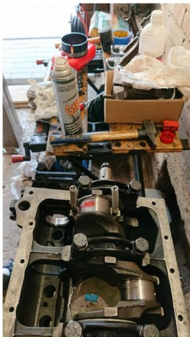
Nous avons ensuite procédé au montage des pistons dans le moteur, en protégeant les filetages des bielles par un caoutchouc, et bien lubrifié les cylindres et les pistons avec le super lubrifiant. Dans la foulée nous avons mis en place l'arbre a came et la distribution avec le lubrifiant spécial. Ps : Les paliers d'arbres a cames ont aussi été changés (avant la mise en place du vilebrequin).
